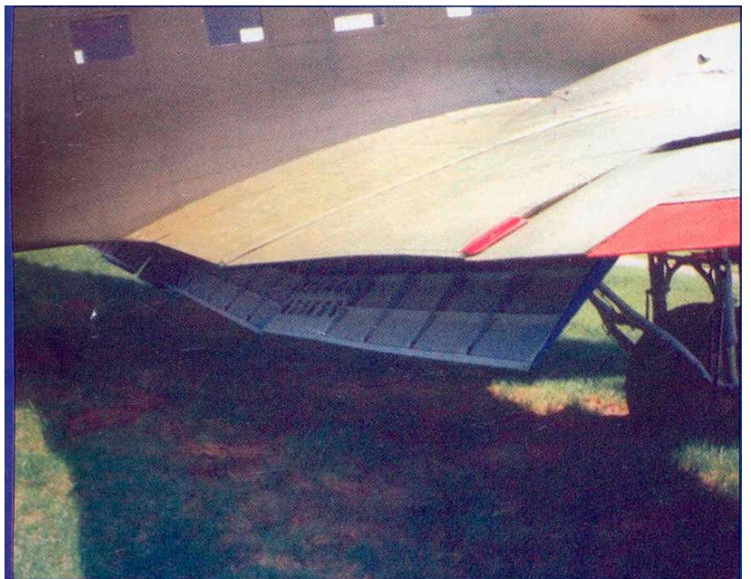
Посадочные щитки в выпущенном положении
