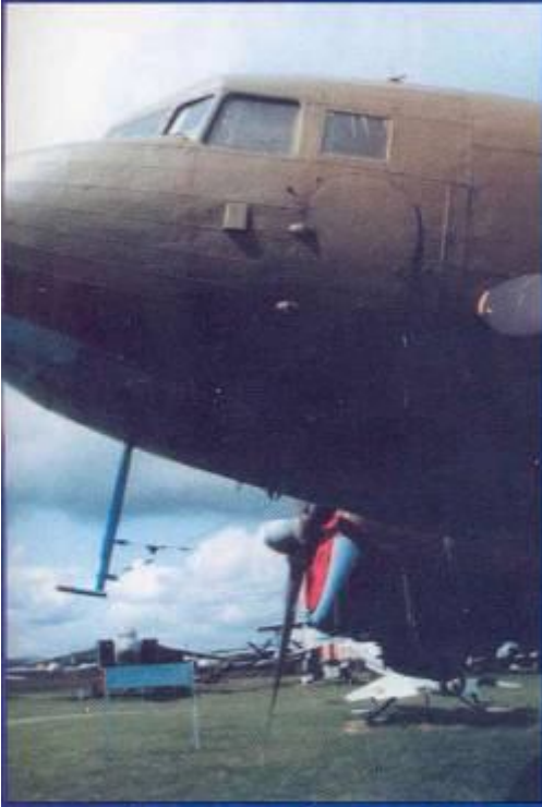
Хорошо видна запасная дверь в кабину экипажа. Верхняя наклонная антенна УКВ-радиостанции установлена при модернизации машины
