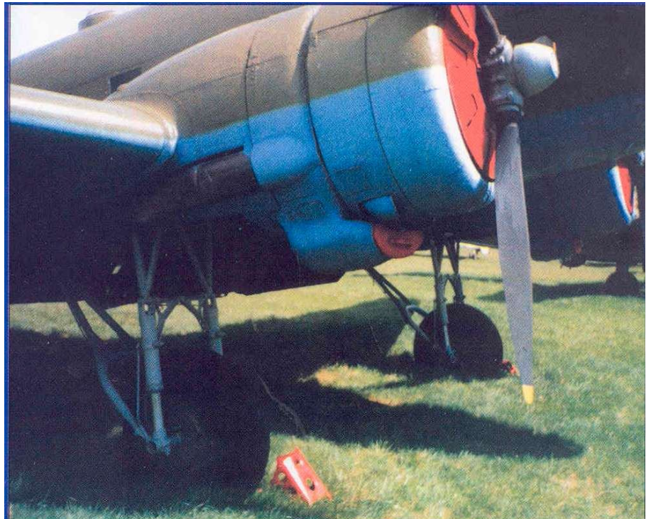
Мотогондола и основная стойка шасси. Обратите внимание на съемный зимний лобовой щит капота и кок винта с демонтированным храповиком. Над фюзеляжем виден полукруглый блистер, характерный для УчШЛи-2
