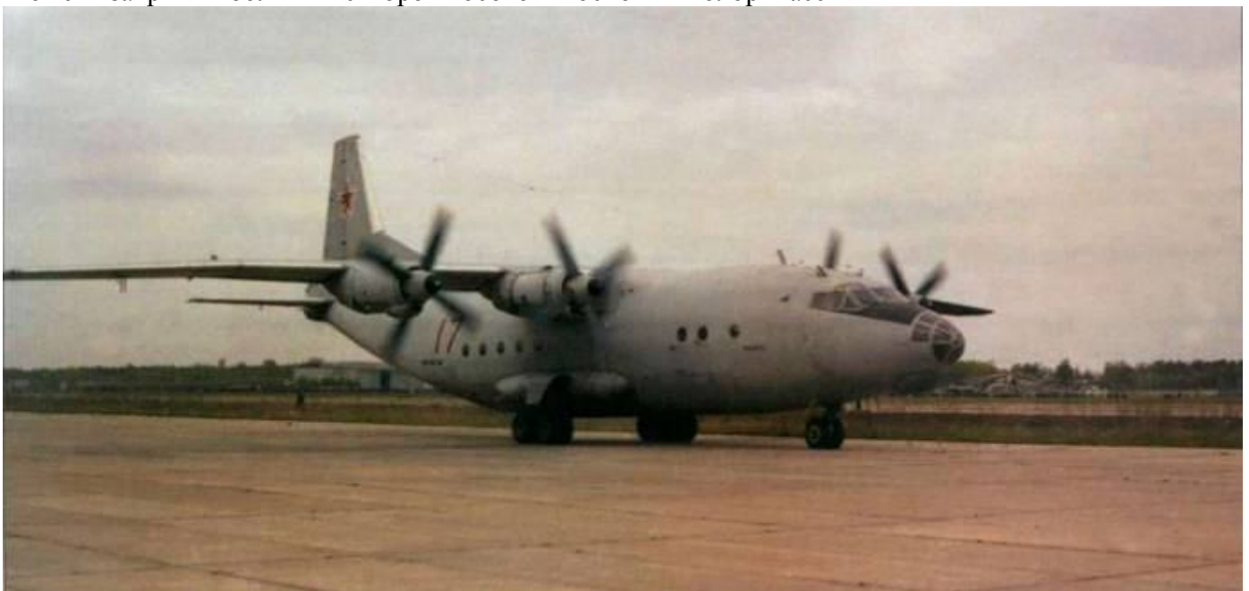
На земле большие створки носовой и основных опор закрыты
