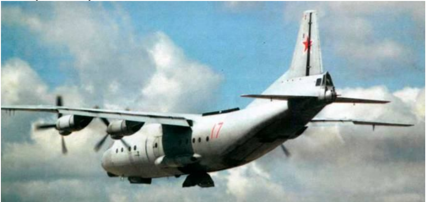
Момент закрытия больших створок носовой и основных опор шасси
